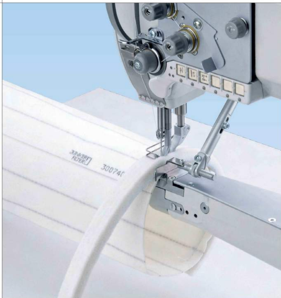
669-180112 CLASSIC Silverline – kantengleiches Vernähen von Dicht- filzen auf Röhrenfiltern
